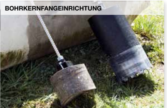
BOHRKERNFANGEINRICHTUNG Der Bohrkern wird sicher an der Vorschubstange gehalten und kann anschließend einfach entfernt werden.
